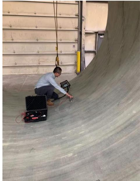
图 8. 使用定制波形算法对 4.9 米直径管道进行超声波检测。
