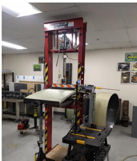
图 2. 用于模拟该项目设计的实际管道的拱形板挠曲测试设置。
